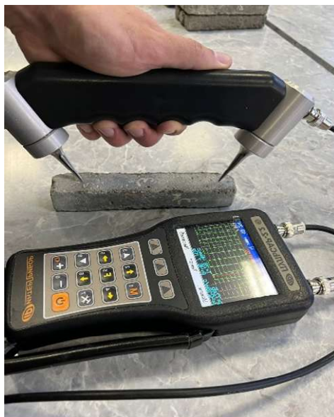
Рисунок 3.5 – Диагностика корродированного образца состава 1:5, твердевшего 13 мес в 1,5 %-м р-ре MgSO_4
