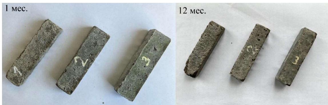
Рисунок 3.6 – Внешний вид образцов, твердевших в 1,5-% р-ре MgSO_4 1 и 12 мес.
