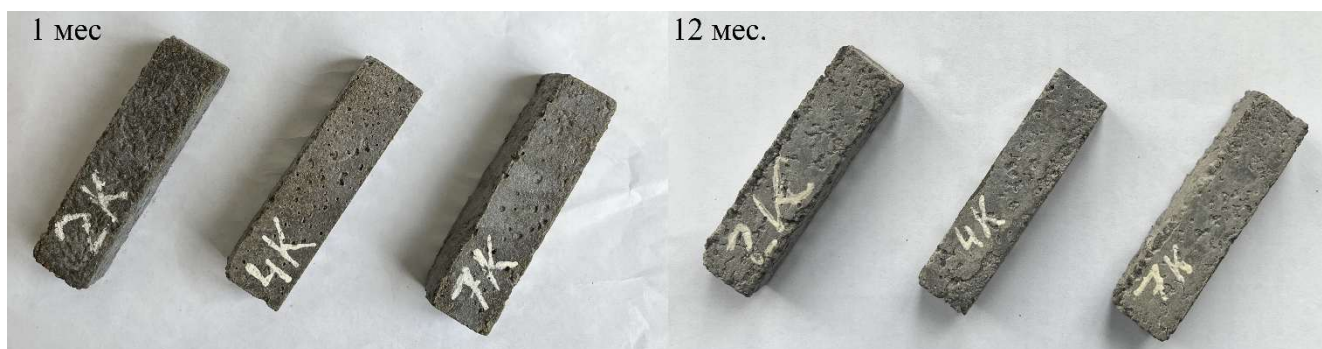
Рисунок 4.3 – Образцы 2К – 20 % микрокварца, 4К – 40 % микрокварца, 7К – 70 % микрокварца в 1,5-% р-ре MgSO_4 в возрасте 1 и 12 мес
