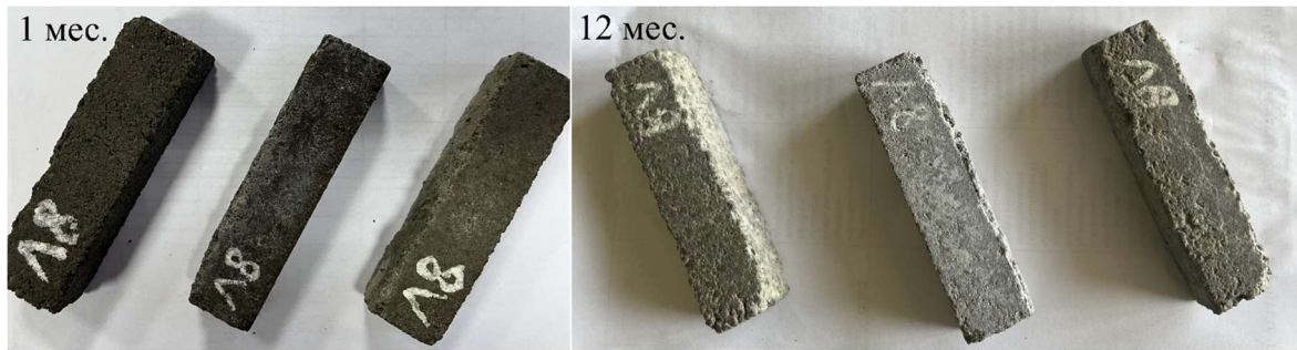
Рисунок 5.16 – Образцы Л8 (слева направо): в воде, в 1,5-% р-ре MgSO 4 , в 1,5-% р-ре Na 2 SO 4 в возрасте 1 и 12 мес
