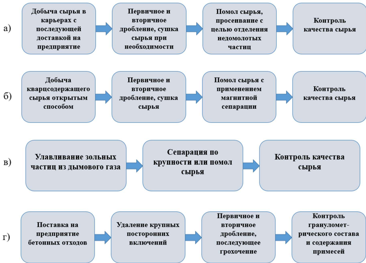
Рисунок 6.2 – Последовательность операций по подготовке молотого известняка (а), микрокварца (б), золы-уноса (в), бетонного лома (г)
